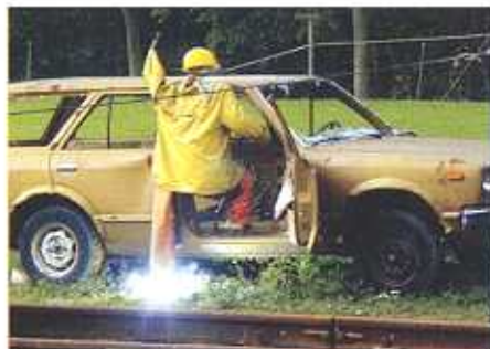
Beim Versuch, ein unter Spannung stehendes Fahrzeug zu verlassen, erleidet der Fahrer einen elektrischen Schlag, denn der Widerstand seines Körpers ist geringer als derjenige der Reifen. Er müsste aus dem Wagen springen, sodass er keinen Kontakt mehr zum Blech hat, wenn er den Boden berührt. (Bilder: CEF)
